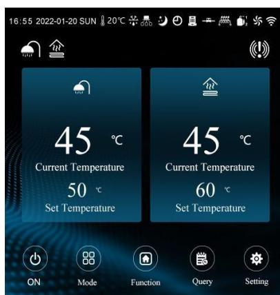
3.3.1. Einzelmodus (Heizung, Kühlung, Fußbodenheizung, Warmwasser), mit Hilfe von “+” oder “-”, oder dem Schieberegler können Sie die gewünschte Temperatur einstellen ; Durch drücken von „Set temperatur“ (Temperaturwert einstellen) erscheint eine Tastatur mit welcher Sie die
