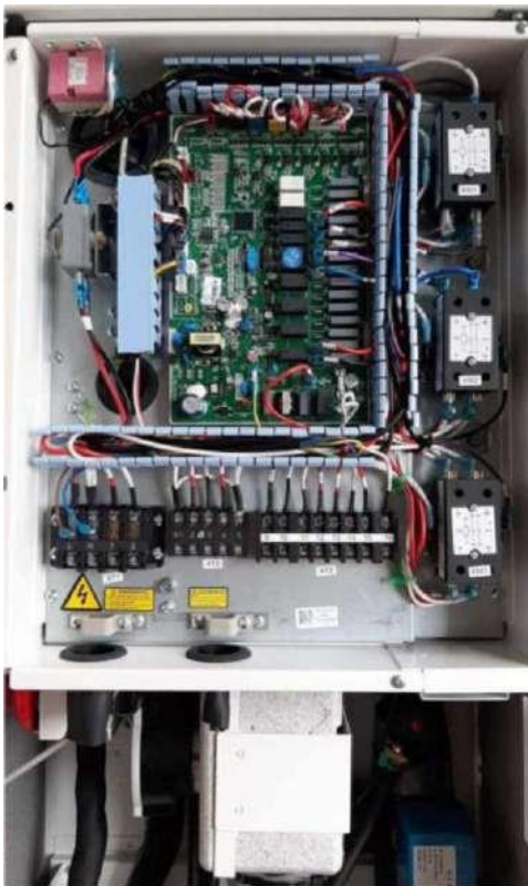
Elektronischer Teil im Innengerät
