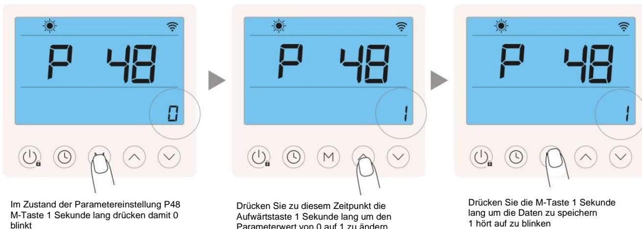
Der Warmwassermodus ist aktiviert, wenn P48 auf 0 eingestellt ist (Werkseinstellung), wobei 7 Modi auf dem Hauptbildschirm ausgewählt werden können (Warmwasser, Heizung, Kühlung, Warmwasser + Heizung, Warmwasser + Kühlung, Warmwasser + Fußbodenheizung)
