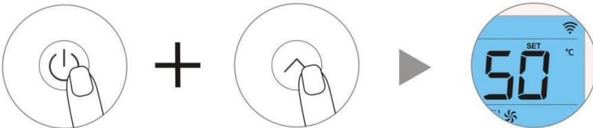
Halten Sie im entsperrten Zustand gleichzeitig die Ein/Aus-Taste und die Aufwärtstaste gedrückt um in den Modus zu starten
