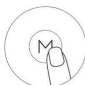
Drücken Sie die M-Taste für 1 Sekunde um zum Parameterwert wechseln
