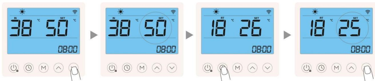
Drücken Sie die Abwärtstaste im eingeschalteten Zustand 1 Sekunde lang um in den Temperatureinstellungsmodus zu gelangen
