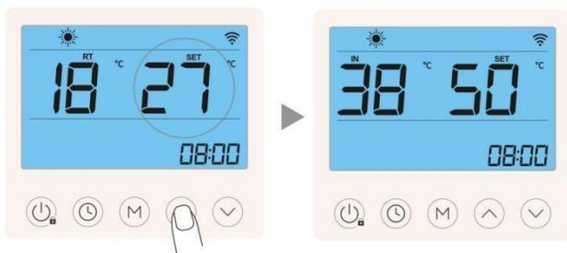
Drücken Sie die Aufwärtstaste um die eingestellte Temperatur zu erhöhen
