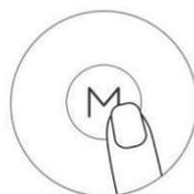
Halten Sie die M-Taste 5 Sekunden lang gedrückt um die P-Parameter Schnittstelle aufzurufen
