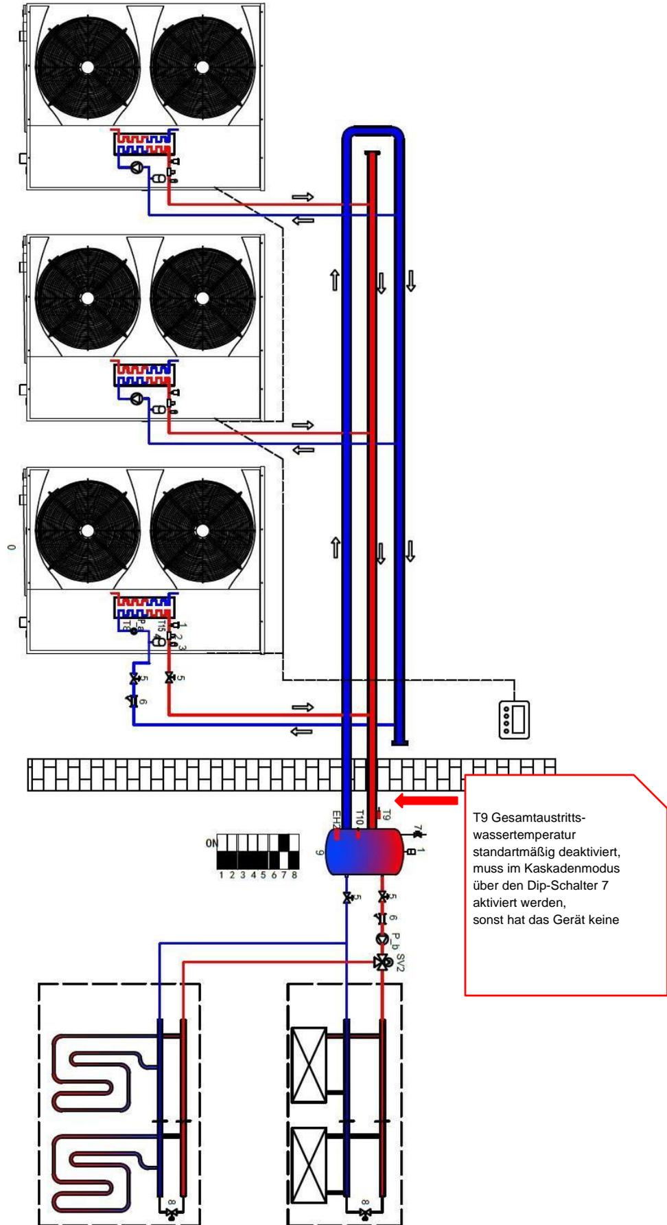
3.7.12 Installation Fußbodenheizung+Kühlung+Warmwasser+ Gaswasserkreislauf
