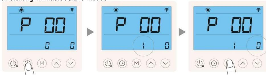
Im Zustand der P00 Parametereinstellung: Drücken Sie die Uhr-Taste 1 Sekunde lang um zur P00 Parametereinstellung des Slave 1 zu wechseln
