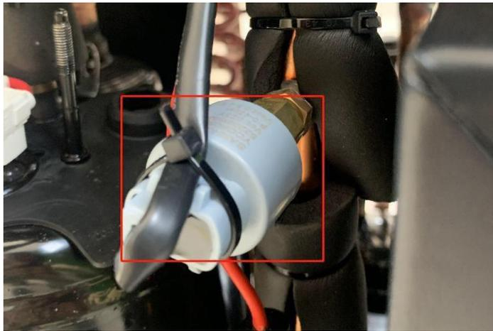
1. Ist die Anschlussleitung des Sensors getrennt oder kurzgeschlossen
