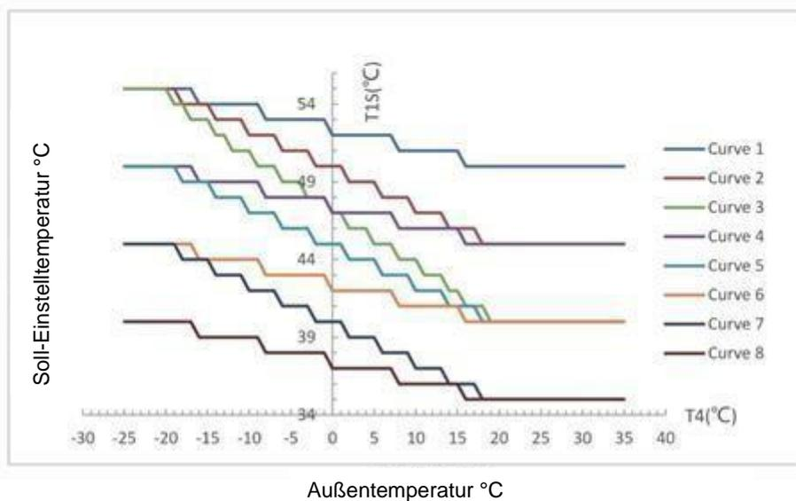
Heizungs-Niederwassertemperatur Klima-Temperatur- Temperaturausgleichskurve CH1-CH8
