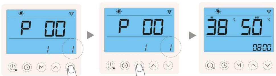
Drücken Sie die Aufwärtstaste um den Wert zu erhöhen, drücken Sie die Abwärtstaste um den Wert zu verringern
