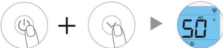
Halten Sie im entsperrten Zustand gleichzeitig die Ein/Aus-Taste und die Abwärtstaste gedrückt um in den Modus zu starten
