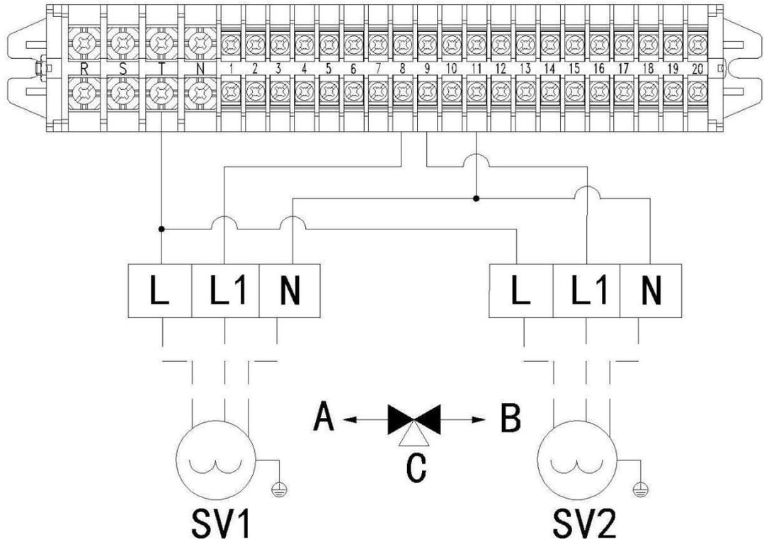
Gemäß der obigen Zeichnung ist C der Eingang und die Ausgänge sind A und B. Wenn die Spannung (VAC230V) nur an die L-Leitung angelegt wird, behält das Ventil die Ausgangsposition C-B bei, d.h. der Durchfluss fällt von C nach B. Wenn die Spannung an die L1-Leitung angelegt wird, fällt das Ventil in die Position C-A, d.h. der Durchfluss fällt von C nach A. Wenn die Spannung von der L1-Leitung entfernt wird, fällt das Ventil zurück in die Position C-B
