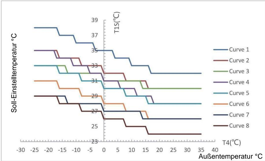
Kühlung Hochwassertemperatur Klima-Temperaturkompensationskurve CH1-CH8
