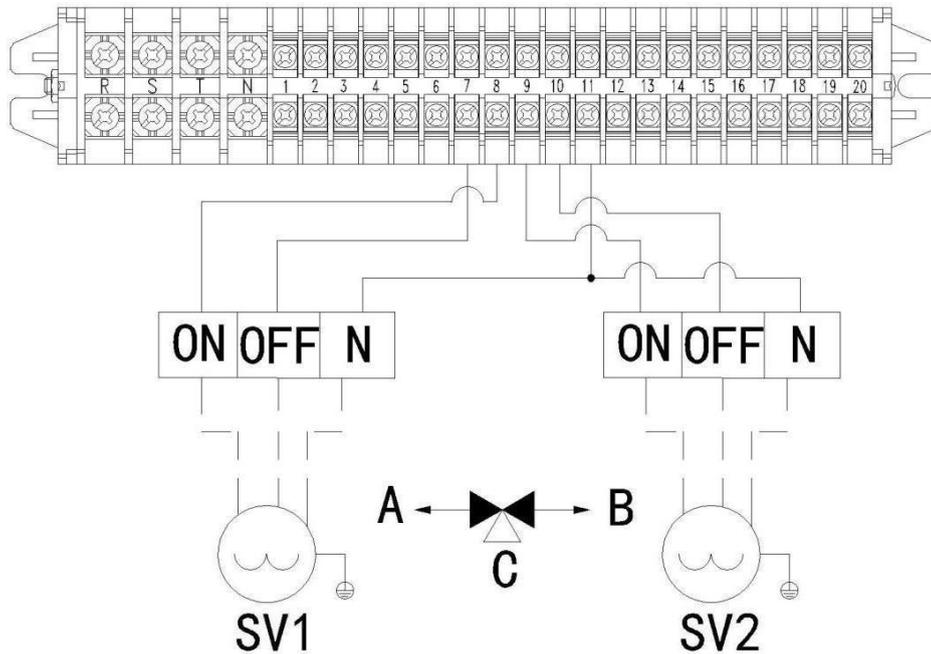
Nach der obigen Zeichnung ist C der Eingang und die Ausgänge sind A und B. Wenn die Spannung (VAC230V) an die ON-Leitung angelegt wird, behält das Ventil die Ausgangsposition C-B bei, d.h. der Durchfluss fällt von C auf Position B. Wenn die Spannung an die OFF-Leitung angelegt wird, fällt das Ventil in die Position C-A, d.h. der Durchfluss fällt von C auf Position A.
