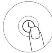
Drücken Sie die Uhr-Taste 1 Sekunde lang und der Minutenbereich blinkt. Sie können die Auf- und Abwärtstasten verwenden um die aktuelle Minute einzustellen
