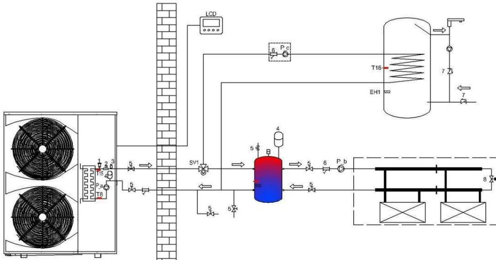
Installationsbedingungen: Warmwasser-Modus, wie z. B. die Verwendung von einen Warmwassertank für die sekundäre Wärmebereitung. Wenn der Widerstand des durchfließenden Wassers zu groß ist, meldet der Durchflussschalter einen Fehler und somit kann es nicht normal gestartet werden. Es muss eine richtige Auswahl der Rohre und des Warmwassertanks getroffen werden.
