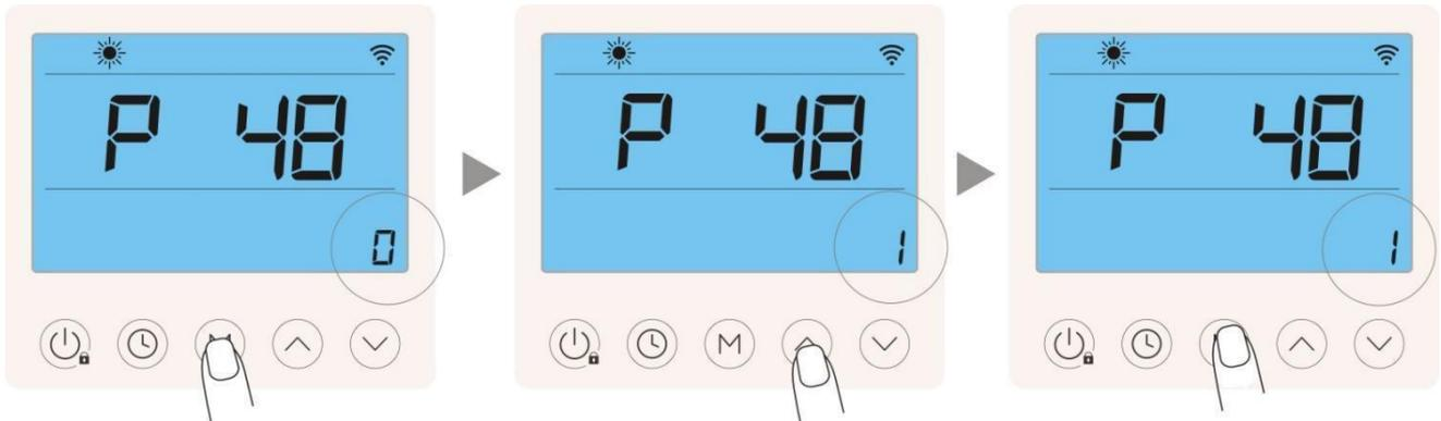
Im Zustand der Parametereinstellung P48 M-Taste 1 Sekunde lang drücken damit 0 blinkt
