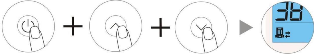
Halten Sie im entsperrten Zustand die Ein/Aus-Taste und die Auf- und Abwärtstasten gleichzeitig gedrückt um den Modus zu starten
